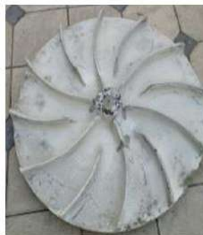
2-rasm. Chap tomonda kompozit polimer materialda quyilgan parrak va o'ng tomonda unga ishlov berish jarayoni.
