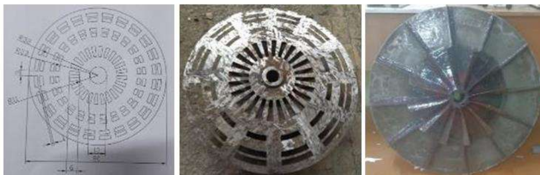
4-rasm. Chap tomonda parrak diskining lazerda kesish uchun chizma, markazda lazerda kesilgan parrak va o'ng tomonda polimer quyilgan parrakli disk ko'rinishi.
