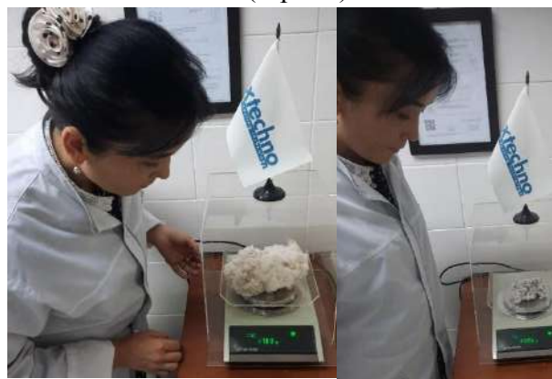
5-расм. Пахта намунасидан олинган тола ва жинланган чигитни массасини аниқлаш жараёнидан лавҳалар
