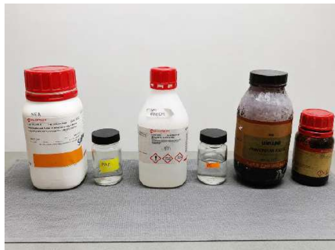
2-rasm. I^-/I_3^- redoks juftligiga ega gel-polimer elektrolit tayyorlashda foydalanilgan kimyoviy reaktivlar: PEO, DMF, EC, PC, TPAI va I_2 .
