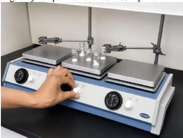
3-rasm. Gel-polimer elektrolit tarkibiy komponentlarini magnit aralashtirgich yordamida bir jinsli holatga keltirish jarayoni.
