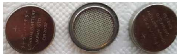
4-rasm. EIS o'Ichovlari uchun elektrolit namunalari.
